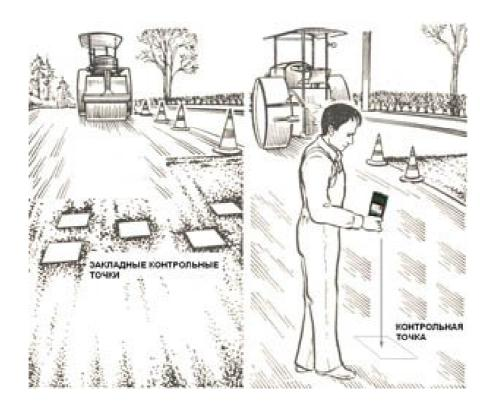
1.3.1. На неметаллическое основание (дерево, картон, бетон, железобетон, асфальт, пластмасса, стеновые панели), в выбранных и согласованных заранее контрольных точках, приклеивается или устанавливается пищевая алюминиевая фольга толщиной 10 микрон (или более), квадратной формы и размером 25 x 25 мм.
