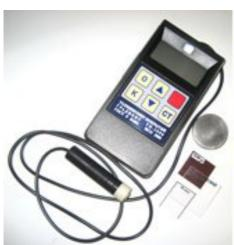
Толщиномер покрытий Градиент ТП-2000 ФН (толщинометрия покрытий на магнитных и немагнитных металлах).
