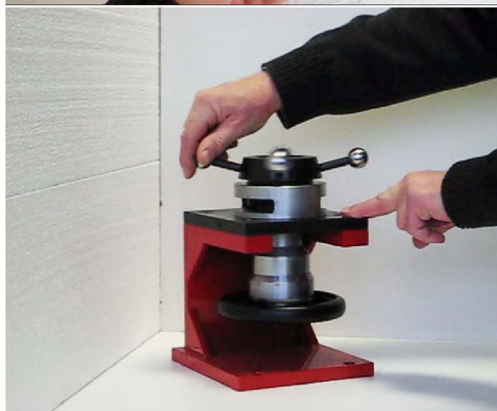
Испытание прочности металлов толщиной от 0,2 мм до 2,0 мм
